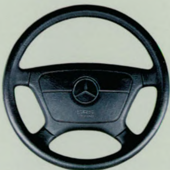
Onder normale omstandigheden merkt u niets van de aanwezigheid van de airbag. Indien nodig, wordt deze in dertig milliseconden opgeblazen.
