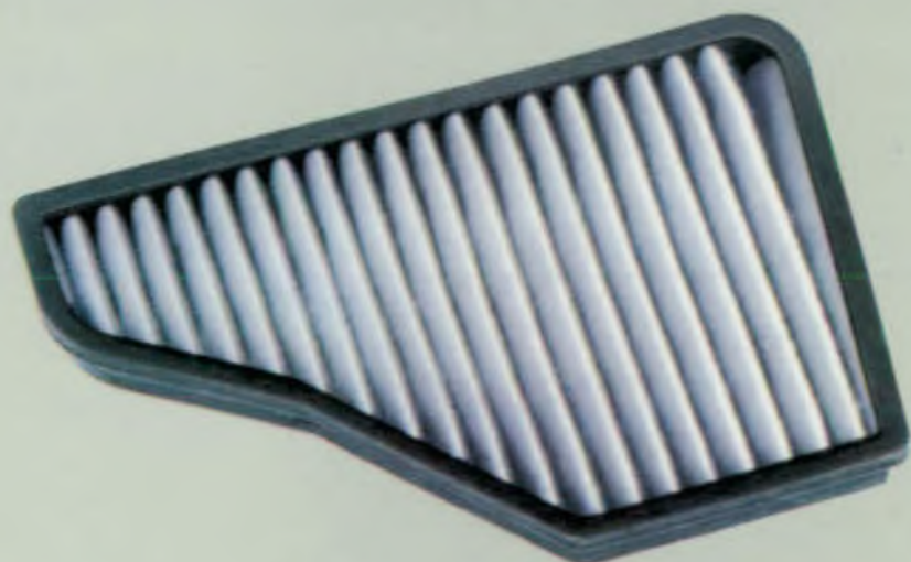
Het elektrostatisch stoffilter zorgt voor een schone lucht.
