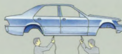
PVC-afdichting van de naden
