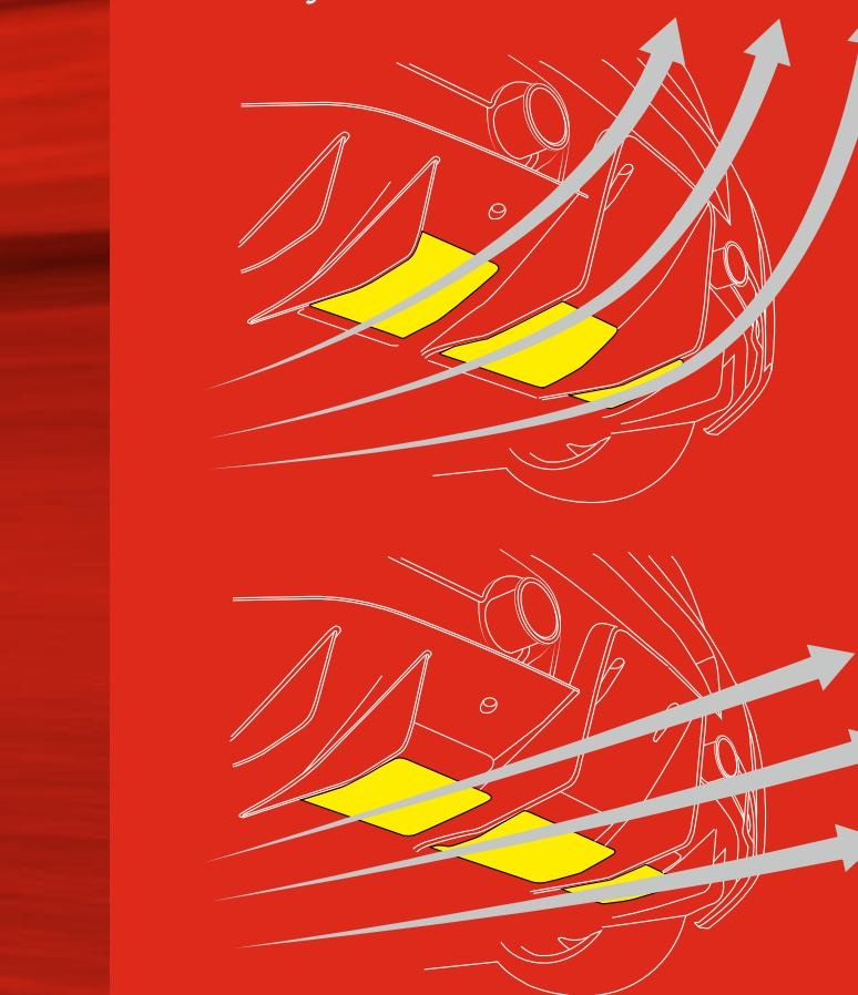
I flap posteriori mobili si alzano e abbassano a seconda delle necessità, per fornire maggior carico aerodinamico o minor resistenza. Possono essere abbattuti e mandare in stallo il diffusore.
