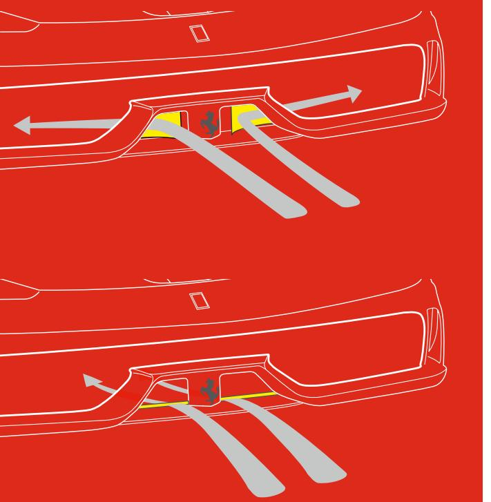
Sopra i 220 km/h il flap orizzontale si abbassa per spostare il carico aerodinamico tra asse anteriore e posteriore, con uno spostamento del 20% verso quest'ultimo.
